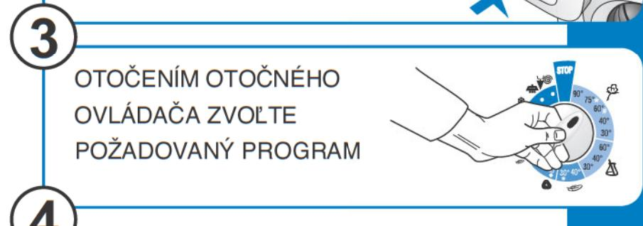
OTOČENÍM OTOČNÉHO OVLÁDAČA ZVOLTE POŽADOVANÝ PROGRAM
